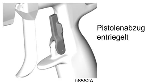
FIG. 3. Abzugssperre
